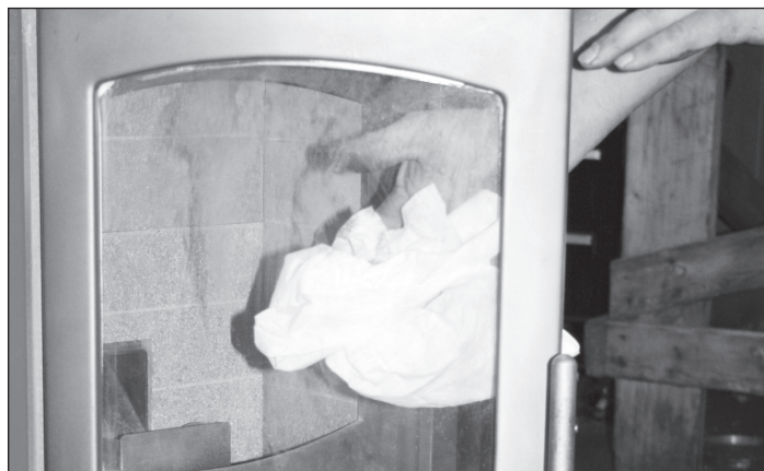
Figure 31 : Essuyer la vitre et contrôler le joint
