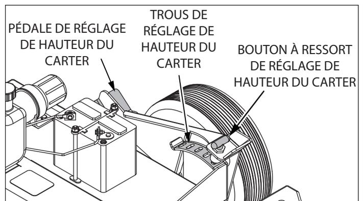
**FIGURE 6 : RÉGLAGE DE HAUTEUR DU CARTER DE FAUCHEUSE.**
