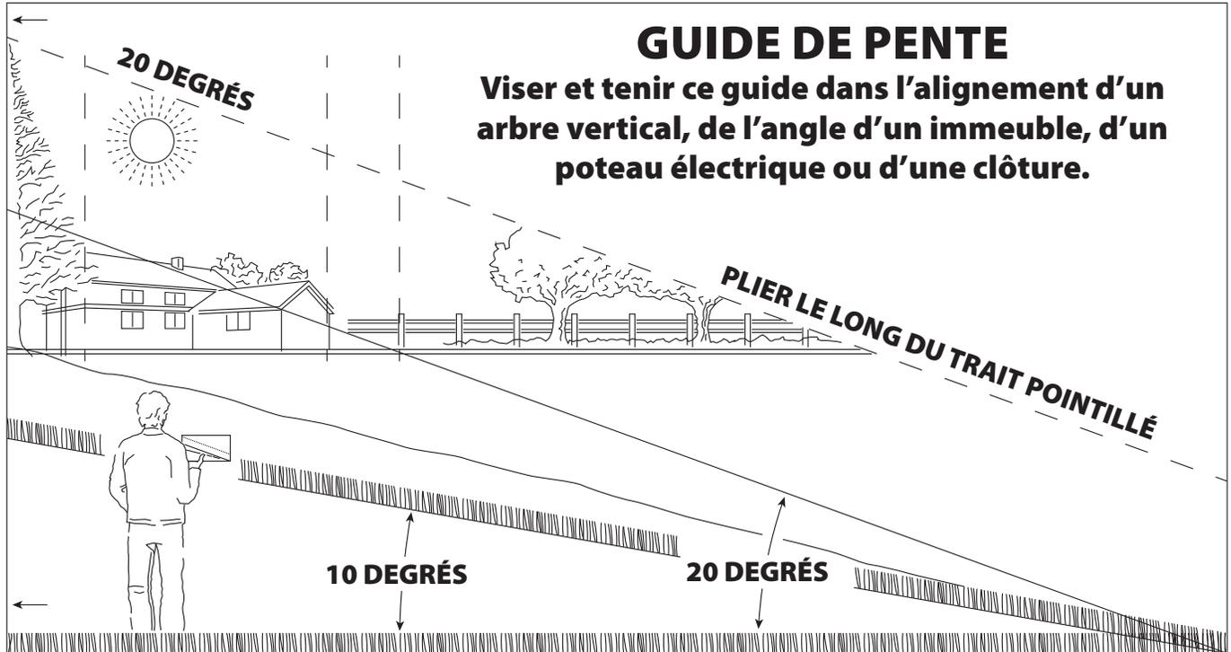
Utiliser ce guide pour déterminer l'angle de la pente.
