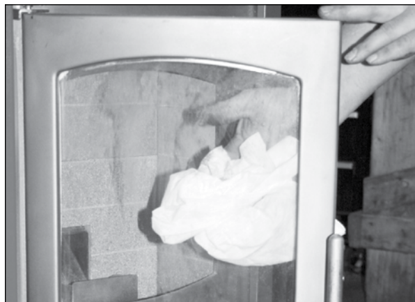
Figura 15: Limpie el vidrio y revise la junta
