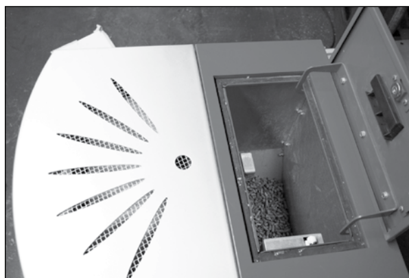
Figura 11: Carga de pellets
