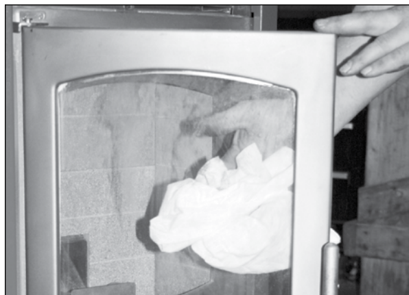
Figure 15 : Essuyer la vitre et contrôler le joint
