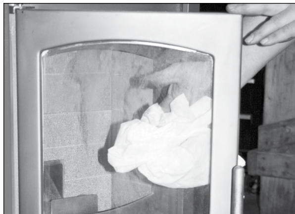
Figura 15: Limpie el vidrio y revise la junta
