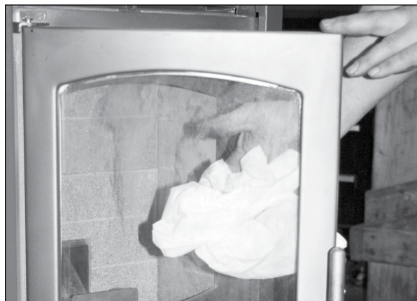
Figure 15 : Essuyer la vitre et contrôler le joint
