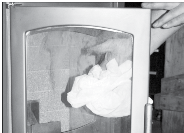
Figura 15: Limpie el vidrio y revise la junta
