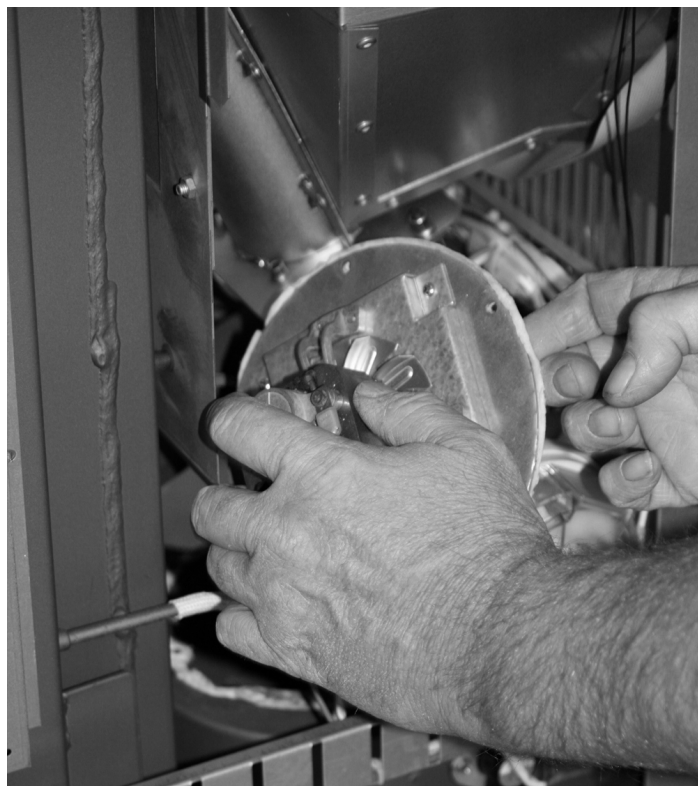
Figure 37 : Enlever le moteur à combustion et nettoyer
