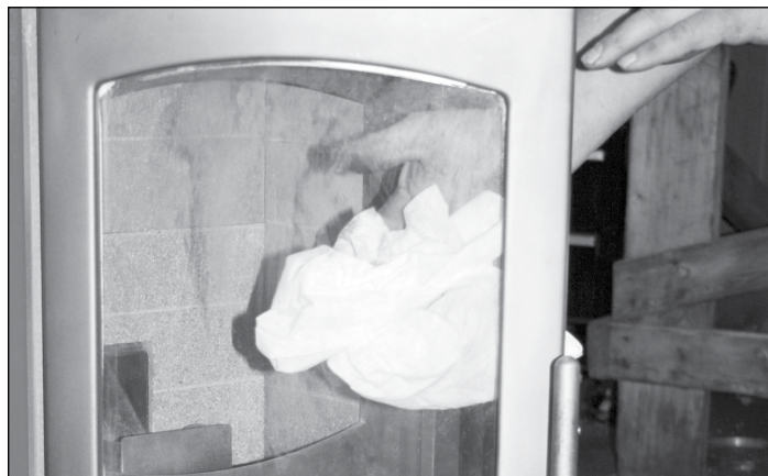
Figure 31 : Essuyer la vitre et contrôler le joint
